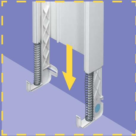
Les ressorts permettent d'ajuster facilement la goulotte sur une hauteur maxi entre 2,45 m et 2,60 m
